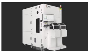
SiC衬底位错无损检测系统
